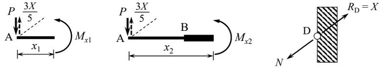
上記に示したひずみエネルギー  $U$  を，点 D に作用する未知反力  $X$  で偏微分する．
