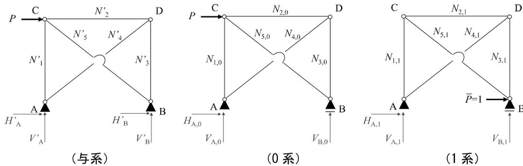
いま、与えられた系の部材力  $N_i$  ( $i=1\sim 5$ ) は、0系（静定系+もと荷重の載荷）と1系（求めたい支点反力に単位荷重を載荷）の部材力を用いて以下のように表すことができる。ここで、 $X$ は求めたい支点Bの水平反力  $H_B$ を表している。また、以下の式における右辺の部材力  $N$ の添え字は、1つ目が部材番号、2つ目が0系または1系を表している。なお、以降では、与系の  $N$ は  $N$ として記載する。
